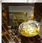
Mantenimiento facil y seguro aceite limpio en aprox. 5 minutos. Meta VITO en la freidora caliente a temperatura de servicio. Simplemente pulse el boton star ya esta.
